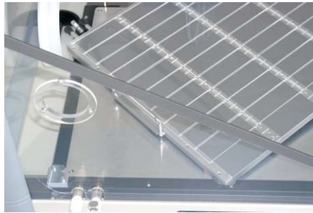
Abnehmbares Sliddeck mit unterliegender Kühlplatte und Temperatursensor
