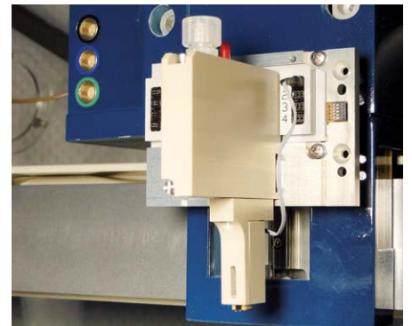
Für die Dosierung einer größeren Anzahl kleinster Tropfen (ab 10 Pikoliter) können die piezoelektrischen GESIM-Pipetten um ein Reservoir (Volumen 3 Milliliter) ergänzt werden.
