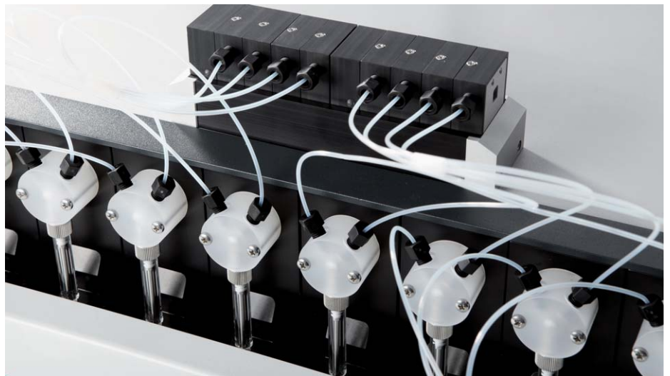
8-fach Flussensormodul für einen 8-Kanal Nano-Plotter™
