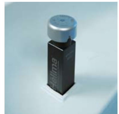
Hellma TrayCell im Kuvettenhalter eines Spektralphotometers
