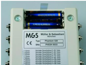
Abbildung 7-1: Batteriefach des phantom 320
