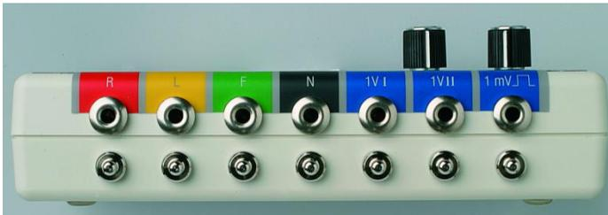
Abbildung 6-1: Vorverstärktes EKG und 1mV Rechtecksignal
