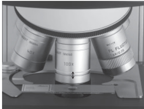
Fig. 44 Objectif à immersion, verrouillé
