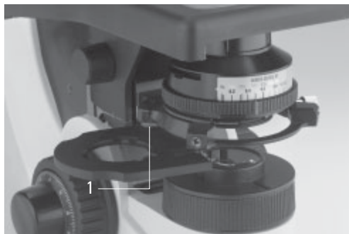
Fig. 19 Montage du porte-polariseur
