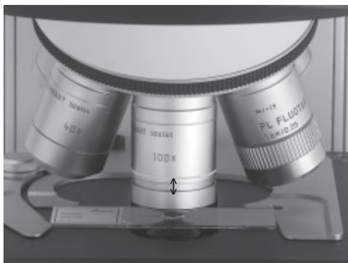
Fig. 43 Objectif à immersion, déverrouillé
