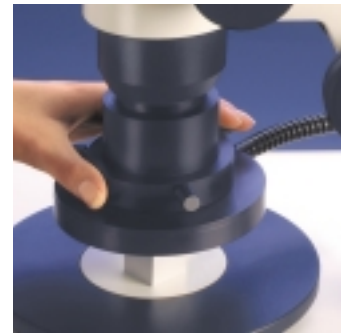
Einfaches Drehen an der stellbaren Ringleuchte für Auflicht-Dunkelfeld sorgt für eine Variierung des Kontrastes.
