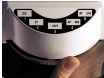
Schneller Wechsel der Mikroskopierverfahren
