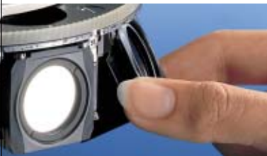
Austausch der Filterwürfel –die Push&Click Technik
