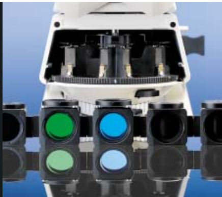
Austausch der Filterwürfel –die Push&Click Technik
