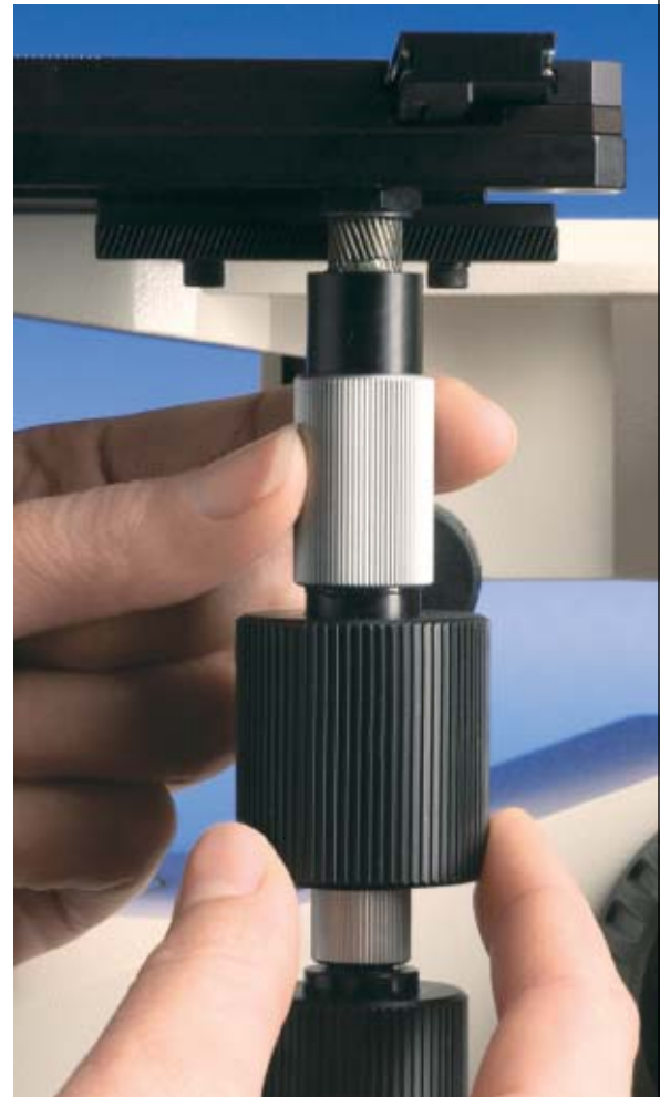
Frei höhenverstellbare Bedienelemente am Tischtrieb
