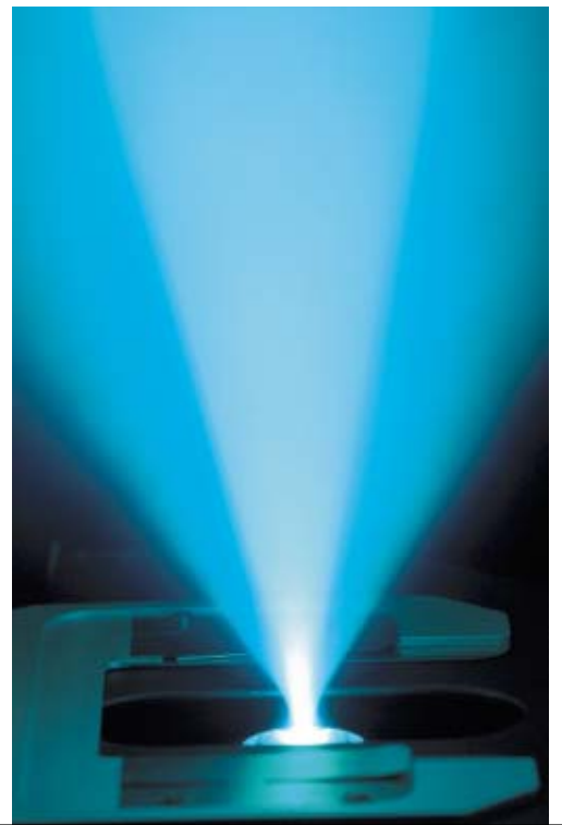
Automatische Anpassung der Kondensorapertur an die Objektivapertur
