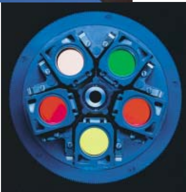
Austausch der Filterwürfel –die Push&Click Technik
