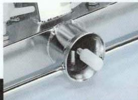
Die vollautomatische Kupplung stellt beim Korbwechsel selbsttätig den Wasseranschluß her.
