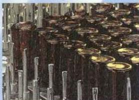
Die INNOVA® L<sup>3</sup> ist auf die unterschiedlichen Reinigungsgüter angepaßt. Die Beschickung ist wahlweise auf einer oder auf zwei Ebenen möglich. Das BHT-Korbprogramm bietet Lösungen für jede Anwendung.
