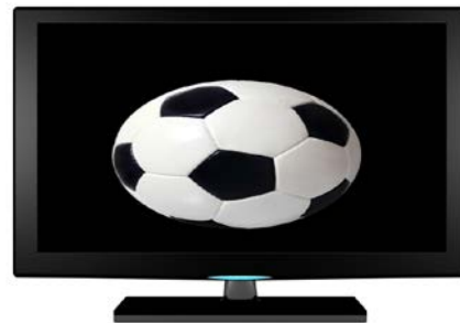
Bild mit Seitenverhältnis 4:3 an einem Bildschirm mit Seitenverhältnis 16:9
