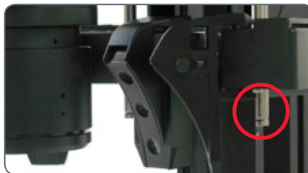
Zu hoch montiert
