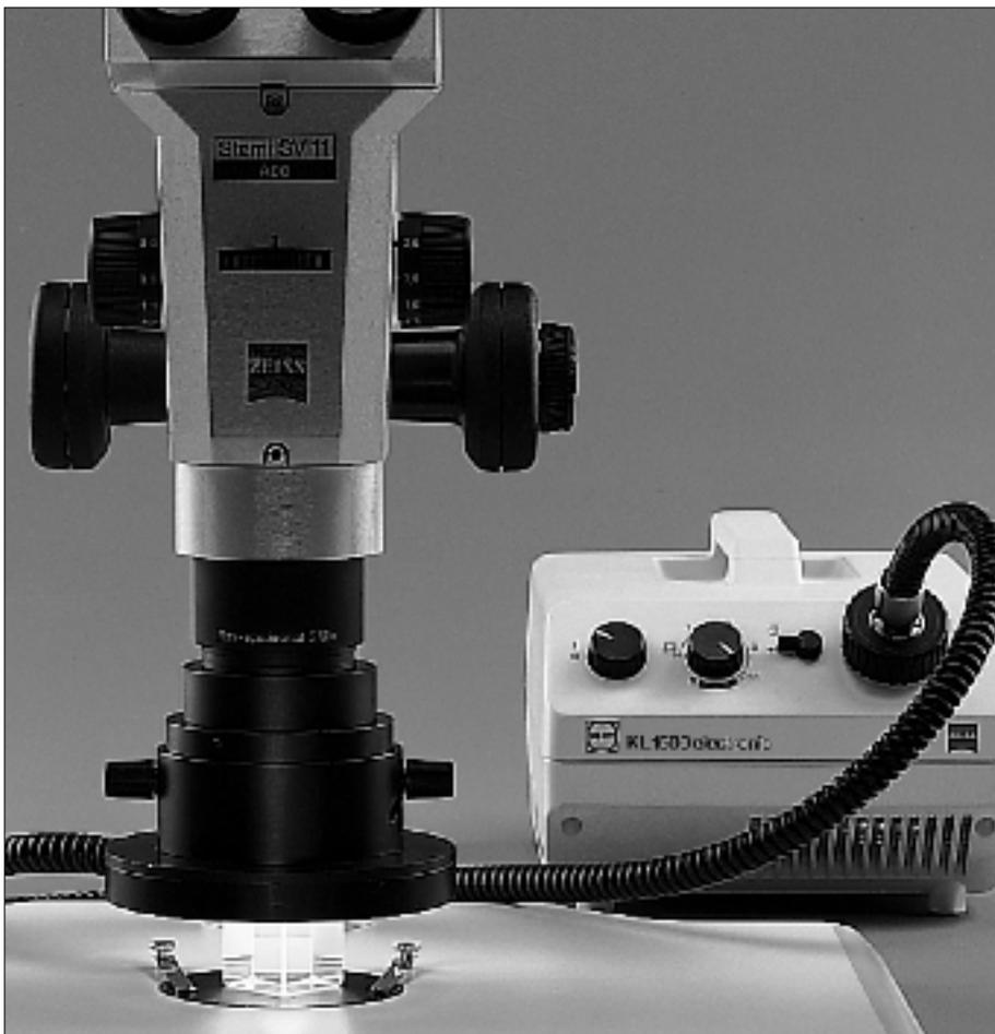
Auflicht-Dunkelfeldbeleuchtung zur Schott KL 1500 electronic am Stereomikroskop Stemi SV 11 Apo
